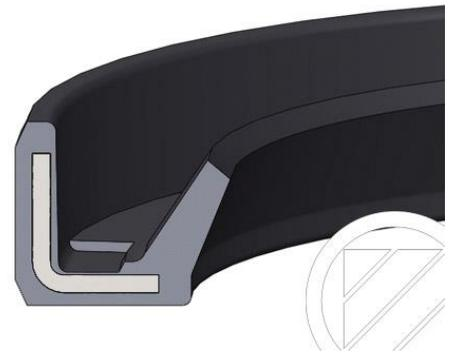
Radial-Wellendichtring in der Standardausführung mit einem elastomeren Außenmantel um einen metallischen Versteifungsring, ohne Zugfeder an der Dichtlippe.
