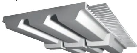
Polyuretanové samovodící řemeny TK a ATK jsou kombinací běžného ozubeného profilu T nebo AT, který je ve svém podélném středu ozubení osazen vodícím klínem. Vlastnosti takovýchto řemenů jsou shodné s běžnými profily T a AT. Řemeny se používají v transportní technice, kdy na řemeny často působí boční síly.
