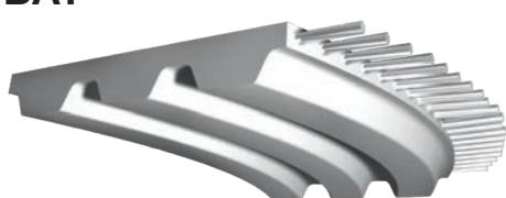
Polyuretanové samovodící řemeny BAT jsou dalším krokem ve vývoji profilu zuba. Tvar zuba vychází z profilu AT. Ozubení je ale formováno do oblouku. Tím bylo dosaženo zvětšení pracovní plochy ozubení a tím zvýšení přenášeného výkonu. Obloukový tvar zuba zajišťuje řemenu samovodící schopnost. Řemeny jsou určeny pro jednosměrný provoz v náročných aplikacích.
