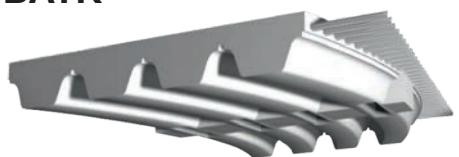
Polyuretanové samovodící řemeny BATK jsou dalším krokem ve vývoji profilu zuba. Tvar zuba vychází z profilu BAT. Obloukové ozubení je ale navíc v podélném středu řemenu osazeno vodícím klínem. Obloukový tvar zuba spolu s vodícím klínem zajišťuje řemenu obousměrnou samovodící schopnost. Řemeny se používají v náročných průmyslových pohonech a lineárních aplikacích.
