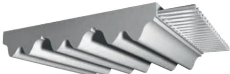
Profil ATP je dalším krokem ve vývoji profilu zuba u polyuretanových řemenů. Oproti řemenům T a AT je každý zub rozdělen na dva menší. Tato optimalizace zuba zlepšila časování, snížila provozní hluk o -10 dB, zvýšila přenášený výkon až o 60% a zároveň prodloužila životnost řemenů. Řemeny profilu ATP jsou pevné řemeny s přesným časováním.
