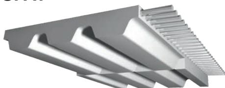
Polyuretanové samovodící řemeny SFAT jsou jednou z modifikací klasického profilu AT (podobně jako profily ATK, BAT, BATK). Profil SFAT obsahuje 2 řady zubů profilu AT vedle sebe, které jsou vůči sobě podélně posunuty. Tím je dosaženo samovodících vlastností řemenu. U pohonu pak není nutno používat řemenice s bočnicemi. Řemeny se používají v náročnějších pohonech podobně jako řemeny profilu AT.
